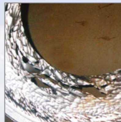
Saugseitige Schleißwände der selben Absorber-Umwälzpumpe, jeweils nach einer Betriebszeit von 16.000 Betriebsstunden
