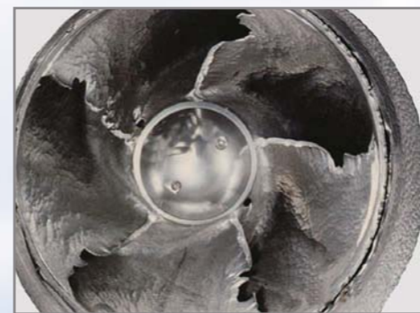
Laufblätter zweier Absorber-Umwälzpumpen nach einer Betriebszeit von 11.000 Betriebsstunden (links) und 24.000 Betriebsstunden (rechts), am selben Einsatzort
